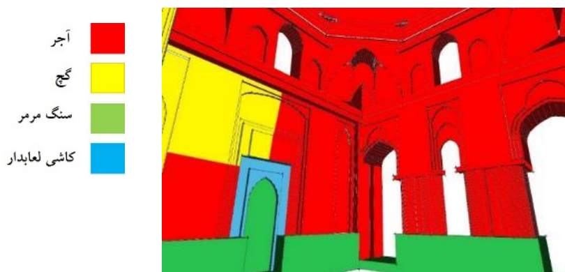
تصویر ۷. تفکیک مصالح بکار رفته در فضای داخلی مدل سه‌بعدی (مأخذ: نگارندگان)
