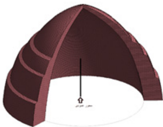
تصویر ۲. مدل‌سازی گنبد آب‌انبار حاج قاضی، نحوه‌ی اجرای گنبد حول محور عمودی (مأخذ: نگارندگان)
